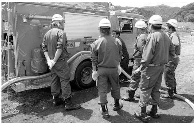
ポンプ車性能点検
